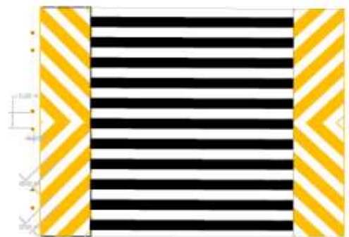
BALIZAMIENTO Y COLOCACIÓN DE BOTONES REFLEJANTES AMARILLOS
