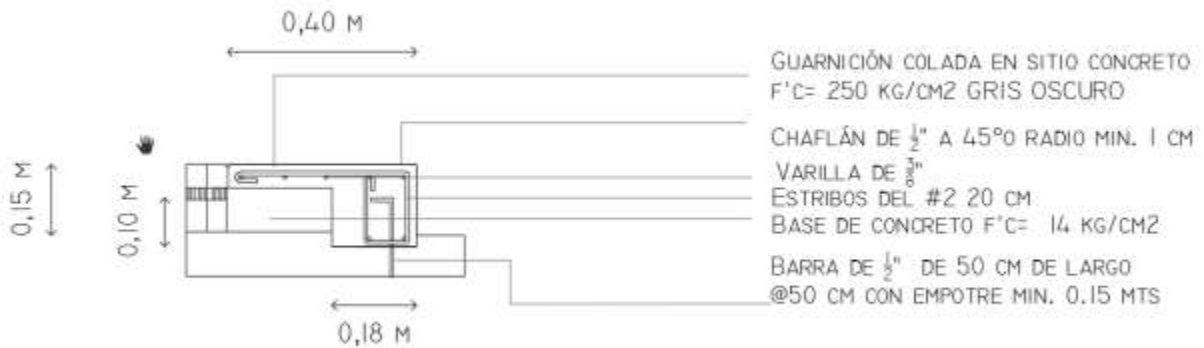
Detalle constructivo de guarnición tipo.
