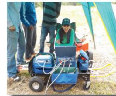
Medición de la resistividad eléctrica del suelo.
