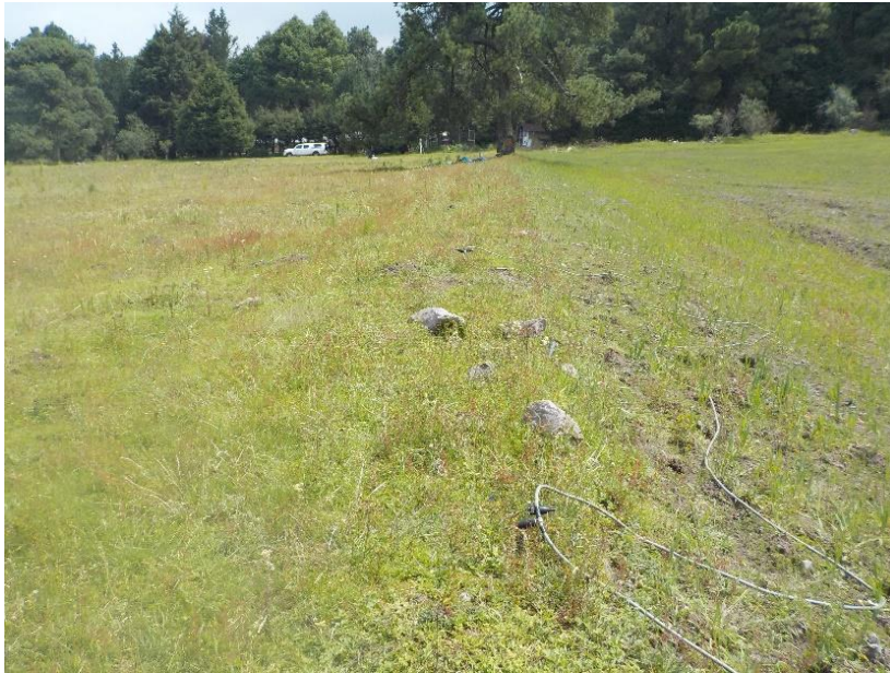
Figura. 6.3.5. Electrodo conectados cada 5 m sobre la línea.
