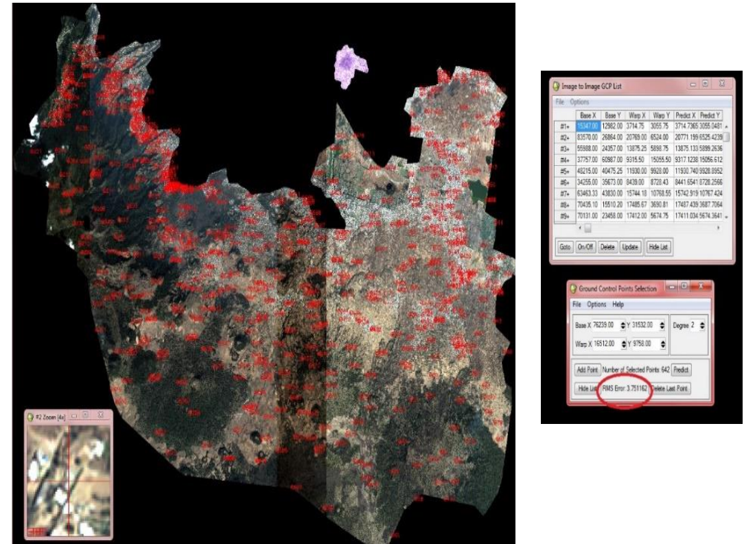
Figura. 5.2.22. Puntos de control colocados y valor RMS obtenido en imagen Quick Bird.
