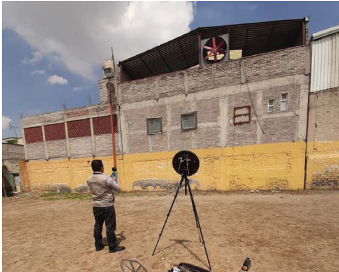
Cámara acústica para medición de ruido
