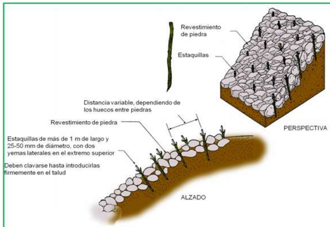
Fig. 43. Esquema de colocación de estaquillas en pedreras.
