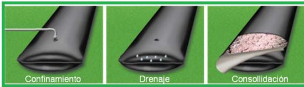
Fig. 17. Etapas del tratamiento de descargas residuales en geocontenedores.
