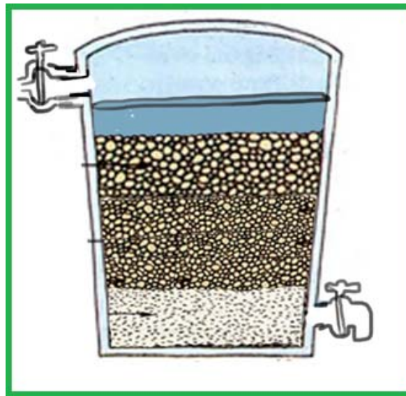
Fig. 18. Esquema de un filtro de arenas y uno de gravas.
