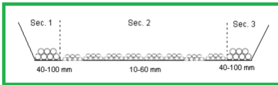
Fig. 19. Esquema de disposición de lecho en un humedal.
