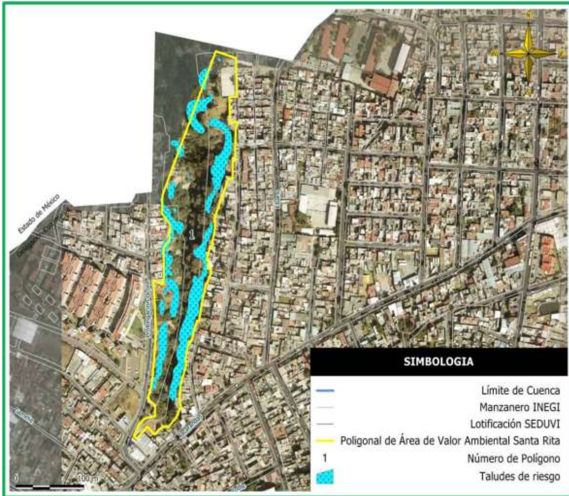
Fig. 6. Se resaltan en color verde, aquellos sitios prioritarios para ejercer tareas de estabilización. Fuente: IQh, S.A. de C.V.
