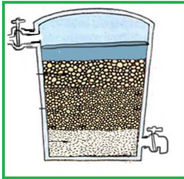
Fig. 22. Esquema de un filtro de arenas y uno de gravas.
