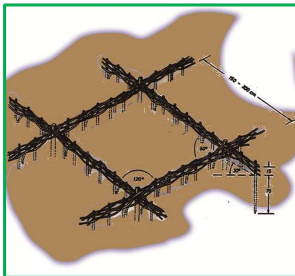
Fig. 39. Colocación en diagonal de empalizadas trenzadas.
