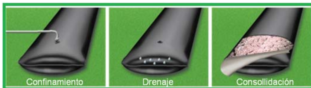
Fig. 21. Etapas del tratamiento de descargas residuales en geocontenedores.
