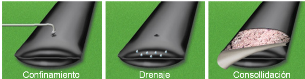
Fig. 21. Etapas del tratamiento de descargas residuales en geocontenedores.
