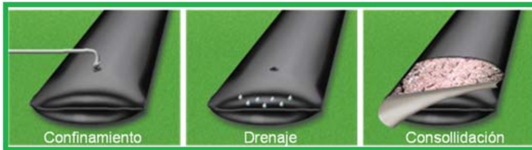
Fig. 20. Etapas del tratamiento de descargas residuales en geocontenedores.
