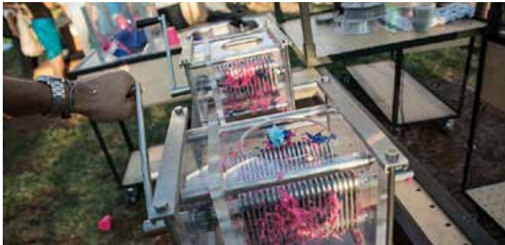
Personas triturando vasos de plástico para su reciclaje en la máquina de Plástico Perpetuo.
