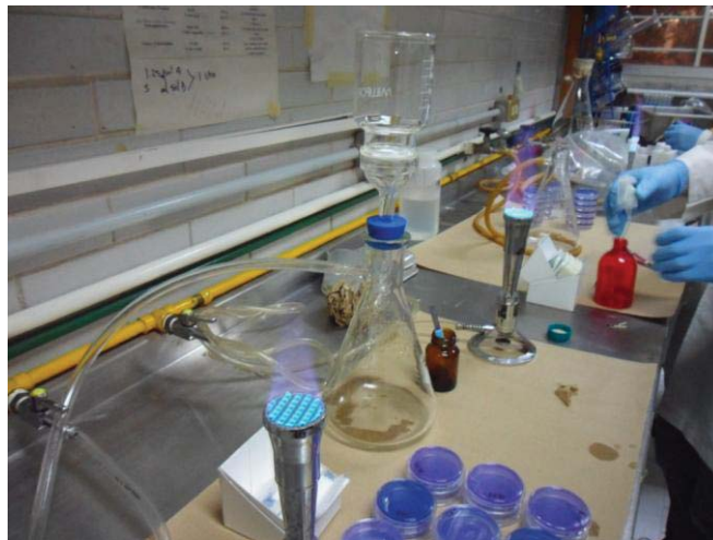
Figura 100. Filtración por membranas para el análisis de coliformes y enterococos fecales.
