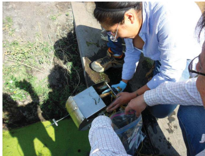
Figura 99. Toma de muestras de sedimento mediante el uso de una draga tipo Eckman.
