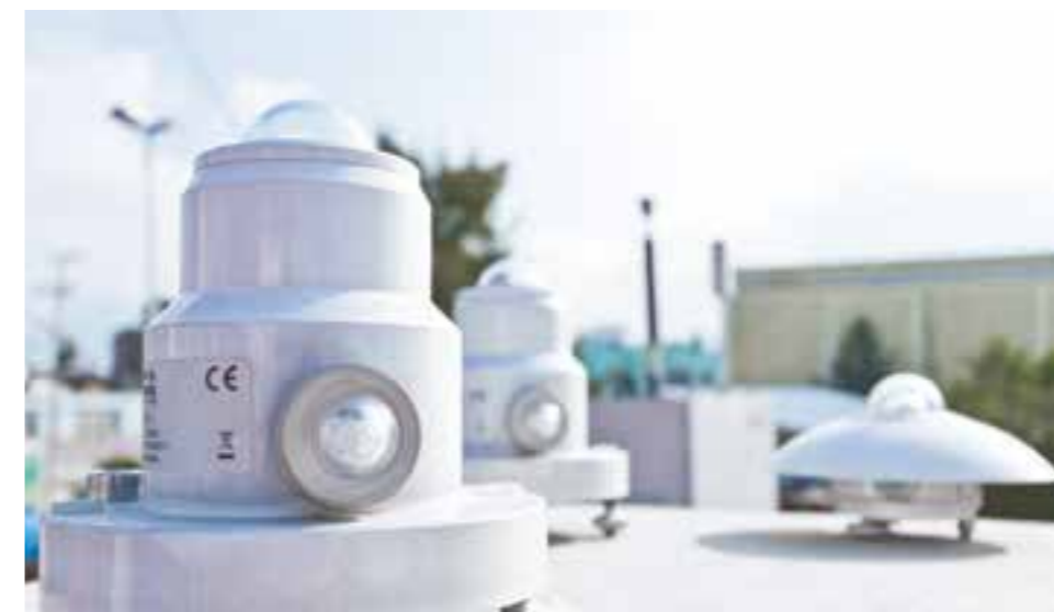
Medidores de radiación UV.
