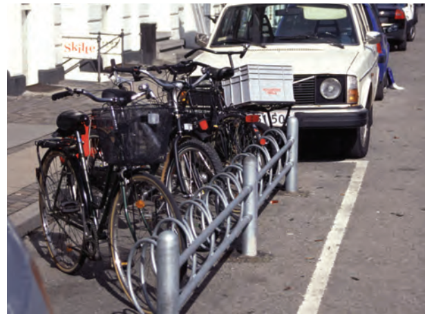
Un espacio para estacionamiento vehicular puede convertirse en 10 lugares de estacionamiento para bicicletas. Copenhague, Dinamarca
