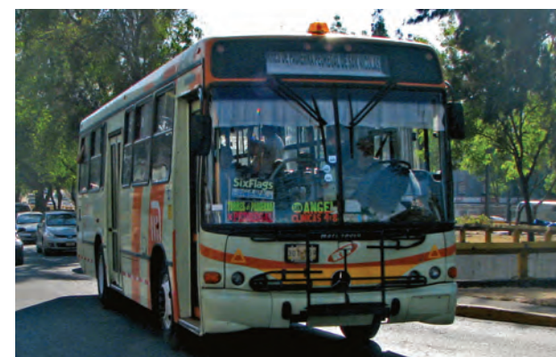
Algunas rutas de autobuses públicos denominados RTP pueden transportar bicicletas mediante un aditamento en su parte delantera. Ciudad de México, México
