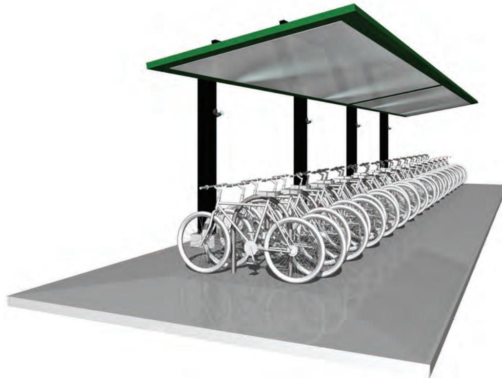
Imagen conceptual de biciestacionamiento semimasivo media capacidad
