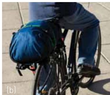
Una parrilla trasera en la que puedes colocar alforjas (a), una mochila con ganchos o con resortes (b), o una caja (d), es la mejor opción para carga pesada porque no desestabiliza a la bicicleta. Si amarras algo, cuida de no sujetar, doblar o tensar de más los cables de los frenos o los cambios.
